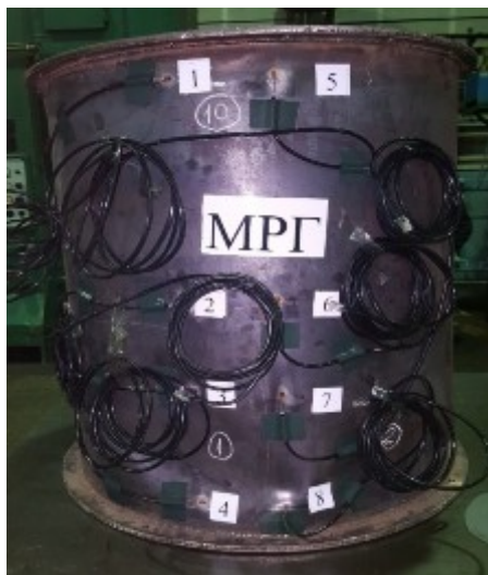
4-расм. Кучайтирилмаган силлик қобик МРГ намунасининг синовдан кейинги кўриниши
