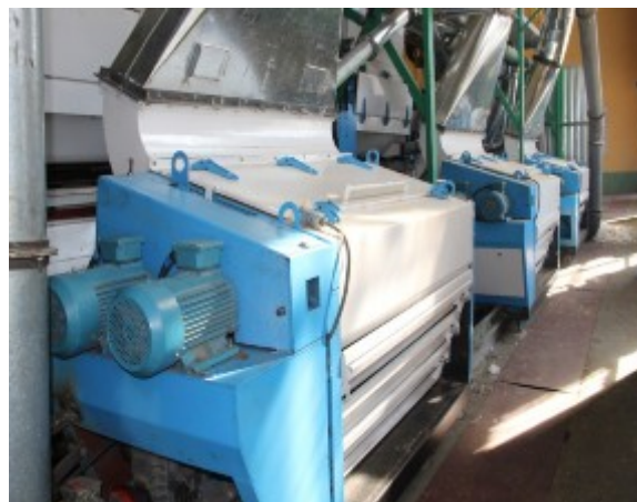
2 - расм. Бахт пахта тозалаш корхонасидаги 5ВП русумли икки барабанли тола тозалагичлар қатори
