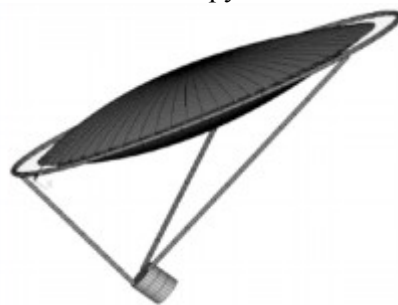
Рис. 7. Надувной рефлектор апертурой 50 м
